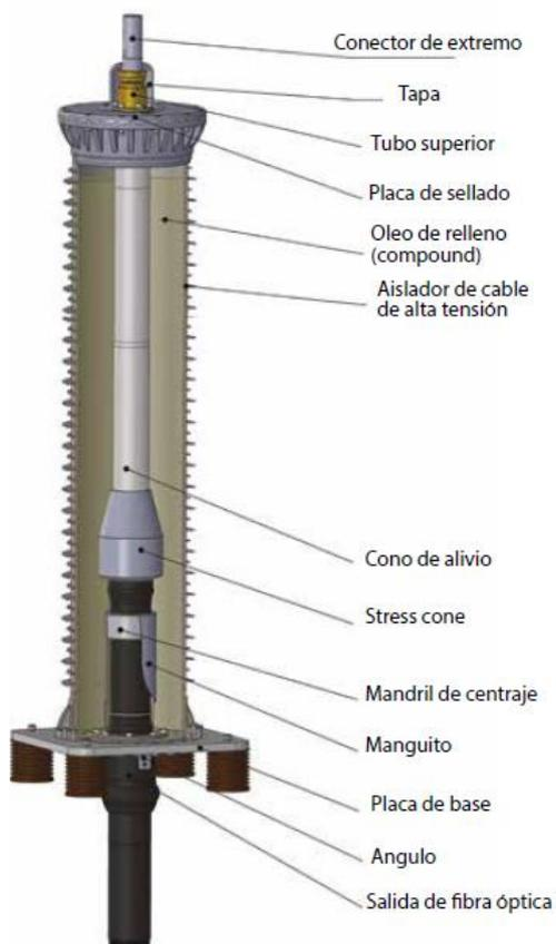
Figura 6: Sección de terminal.
