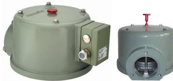
La válvula está también provista de una señal óptica cuando dispara o se abre. Esta señal la origina una varilla que permanece retenida una vez proyectada a través del agujero central de la cubierta, cuando la válvula abre. Para dejar la señal en posición normal (reseteo) una vez desaparecida la sobrepresión, hay que empujar la varilla hacia dentro hasta que apoye de nuevo sobre el cierre.
