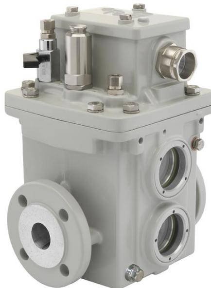
Otra función importante del relé Buchholz es regular el flujo de aceite entre la cuba del transformador y el depósito de expansión. En el caso de que el flujo exceda de un límite de velocidad se activa un contacto de disparo en el relé.
