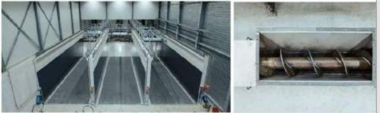
Ilustración 1. Ejemplo de troje de sólidos y tornillo sin fin
